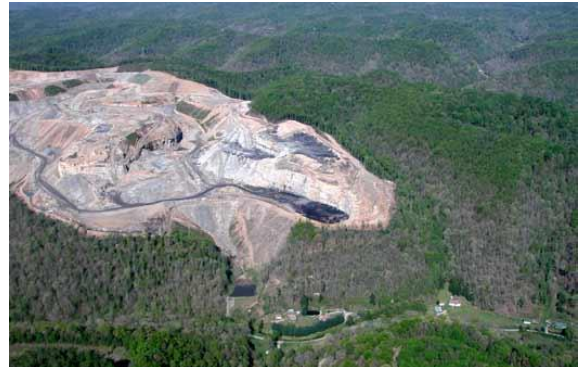
Gambar.8 Skema proses dan hasil penerapan Teknik Penambangan Pengikisan Puncak Gunung 29
