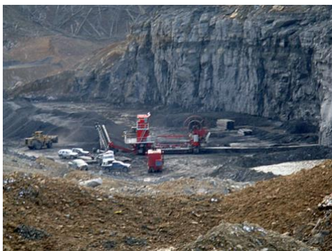
Gambar.7 Skema proses dan hasil penerapan Teknik Dinding Tinggi 28
