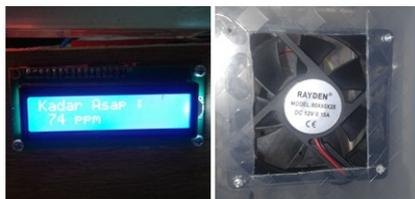
Gambar 22 Sensor MQ-2 Tidak Mendeteksi Tekanan Asap Rokok
