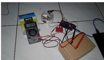
Gambar 15 Uji Teknis Sensor MQ-2 Mendeteksi Adanya Asap
