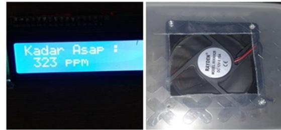
Gambar 22 Sensor MQ-2 Mendeteksi Tekanan dari Asap Rokok
